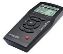
SendoPro 868-A, пульт инженера
